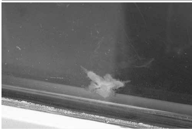
Рис. 3 Результат замерзания многослойного стекла с силикатным гелем
