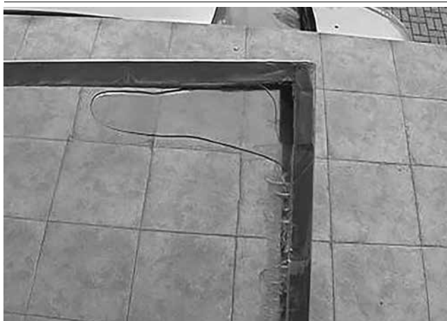
Рис. 1 Воздушные полости в стекле Pyrobel, возникшие в результате нарушения изоляции кромки и попадания воды
